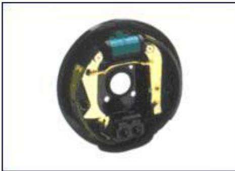
Como las bandas van montadas en el plato (D), sujeto al chasis por el sistema de suspensión y que no gira, es el tambor el que queda frenado en su giro por el frotamiento con las bandas.
