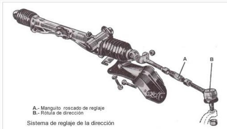
Esta unión se efectúa como se ve en la figura inferior, por medio de una rótula (B), que permite el movimiento ascendente y descendente de la rueda, a cuyo brazo de acoplamiento se une. La biela de unión resulta partida y unida por el manguito roscado de ajuste (A), que permite la regulación de la convergencia de las ruedas.
