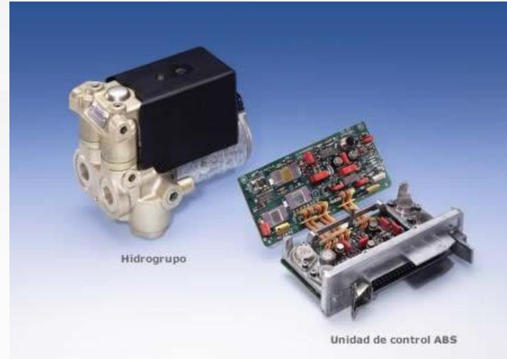
**Conjunto motor-bomba:** Esta es constituido de un motor eléctrico y de una bomba hidráulica de doble circuito, controlados eléctricamente por el computador. La función del conjunto es rechazar el líquido de frenos en el curso de la fase de regulación desde los bombines a la bomba de frenos. Este rechazo es perceptible por el conductor por el movimiento del pedal de freno.
