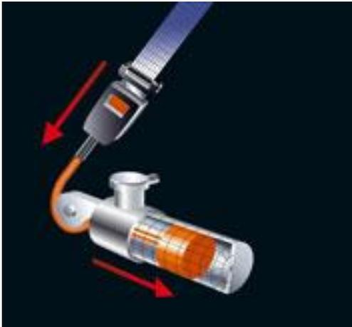
Actualmente los cinturones de seguridad poseen sensores que aseguran el cuerpo en el momento del impacto mediante un resorte o un disparo (tensor pirotécnico).
